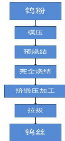
钨丝生产工艺流程图
